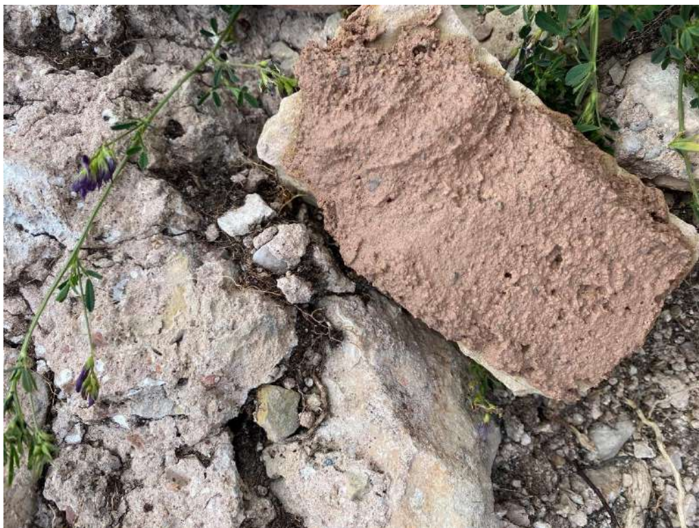
Comparativa de color de morter amb pedres de color semblant al morter original.
