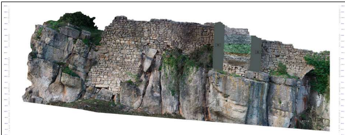
Alçat fotogramètric de la muralla amb diferenciació cromàtica de les tongades constructives de la torre circular A més a més, s'ha pogut evidenciar com, sovint, aquestes tongades constructives coincideixen
