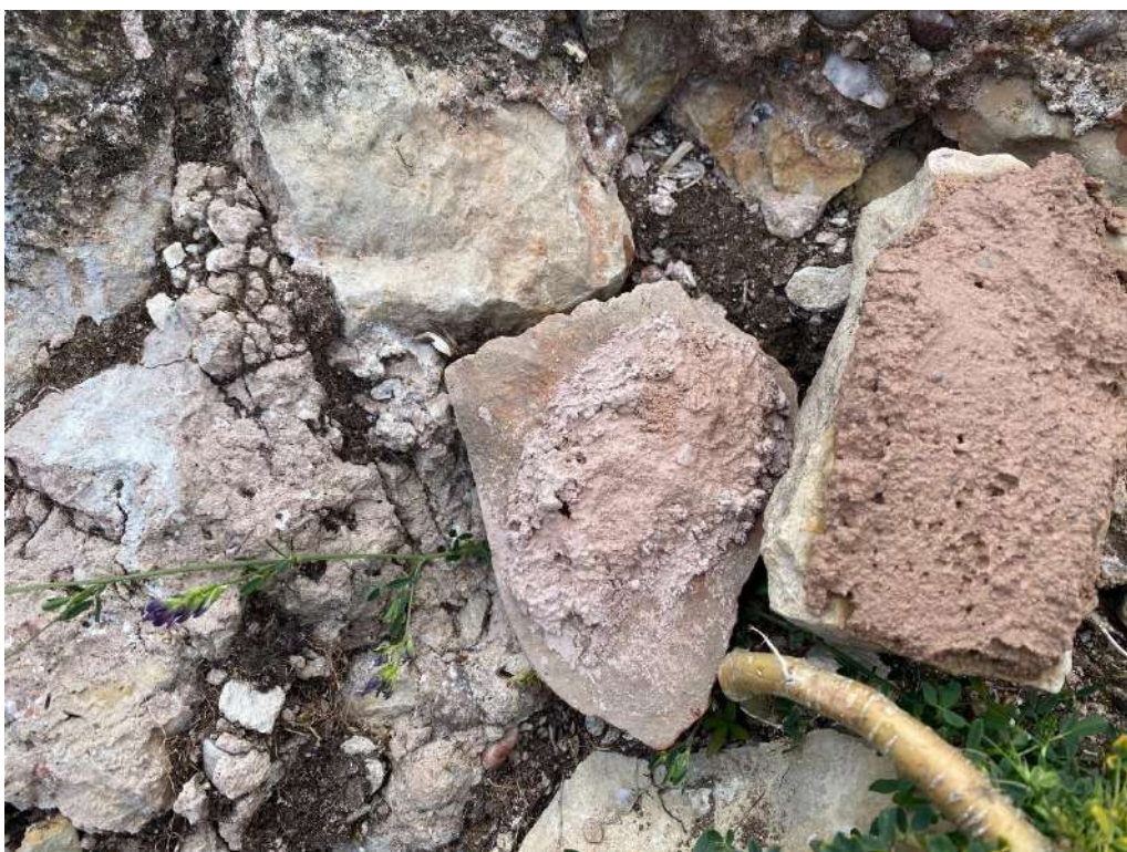
Canvi de color morter de calç acolorit durant el procés d'assecat.
